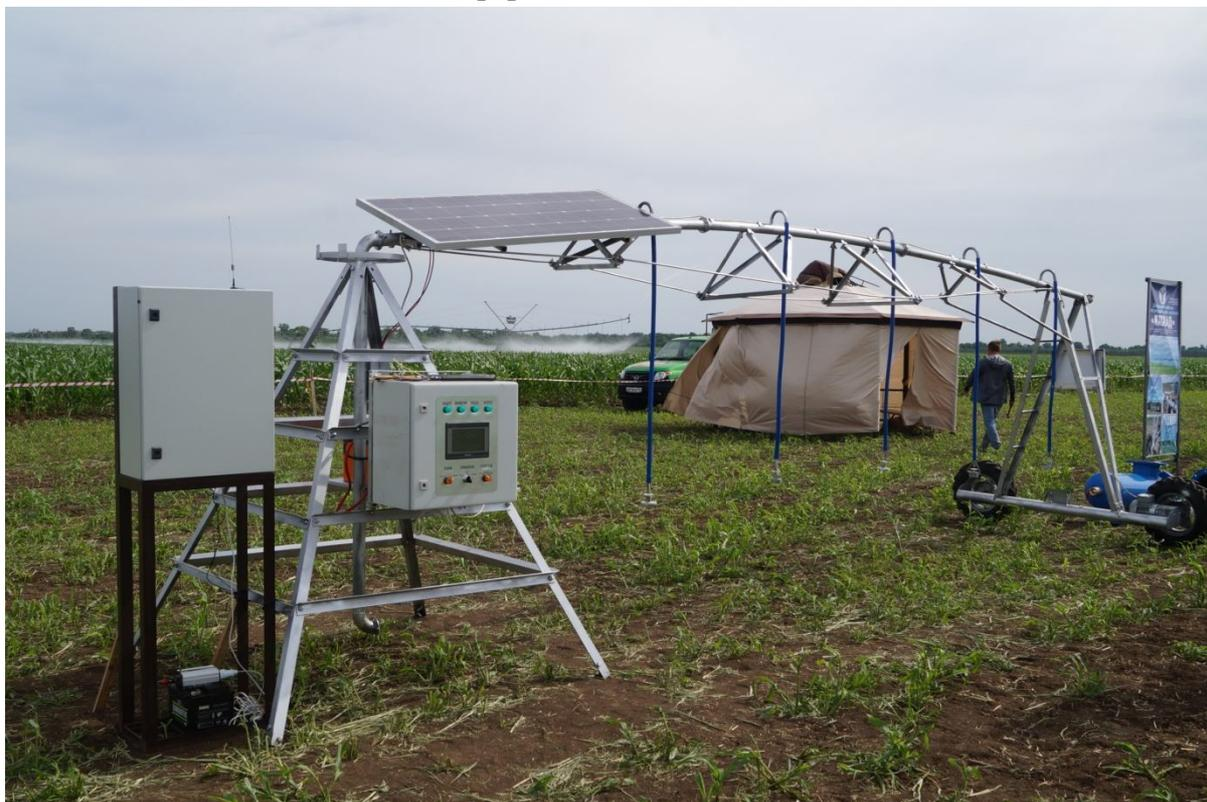
Рисунок 5. Автономная секция дождевальной машины кругового типа с системой питания от солнечного модуля (патент № 189495)
