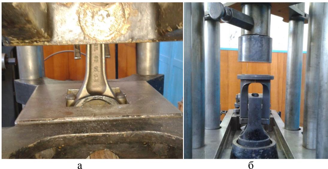
Рисунок 3. Испытания шатунных болтов на растяжение. а – растяжение шатуна с установленными болтами, б – растяжение шатунного болта, установленного в реверсор
