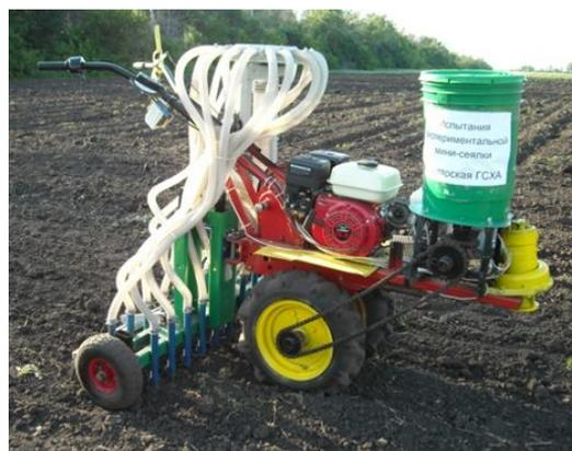
Рисунок 2. Схема и общий вид самоходной пневматической мини-сеялки (обозначение позиций в тексте)
