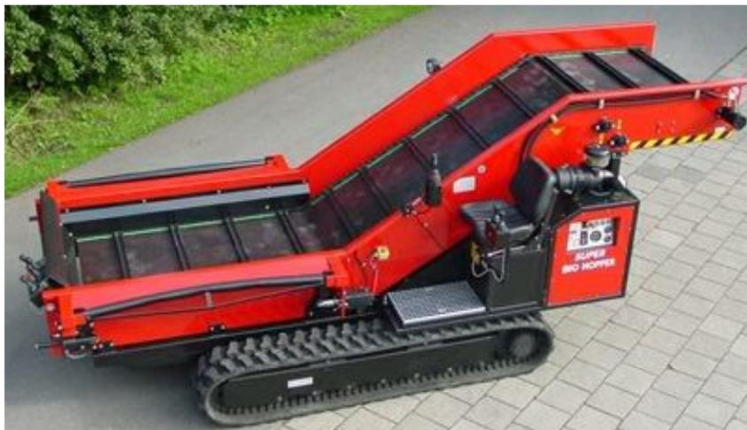
Рисунок 2. Машина для поточного удаления растительных остатков
