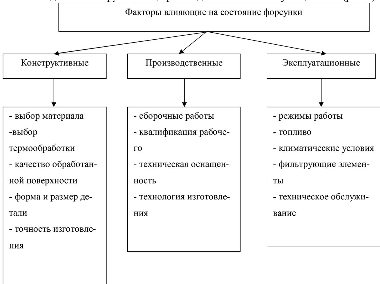
Рисунок 2. Факторы, влияющие на износ распылителей форсунок
