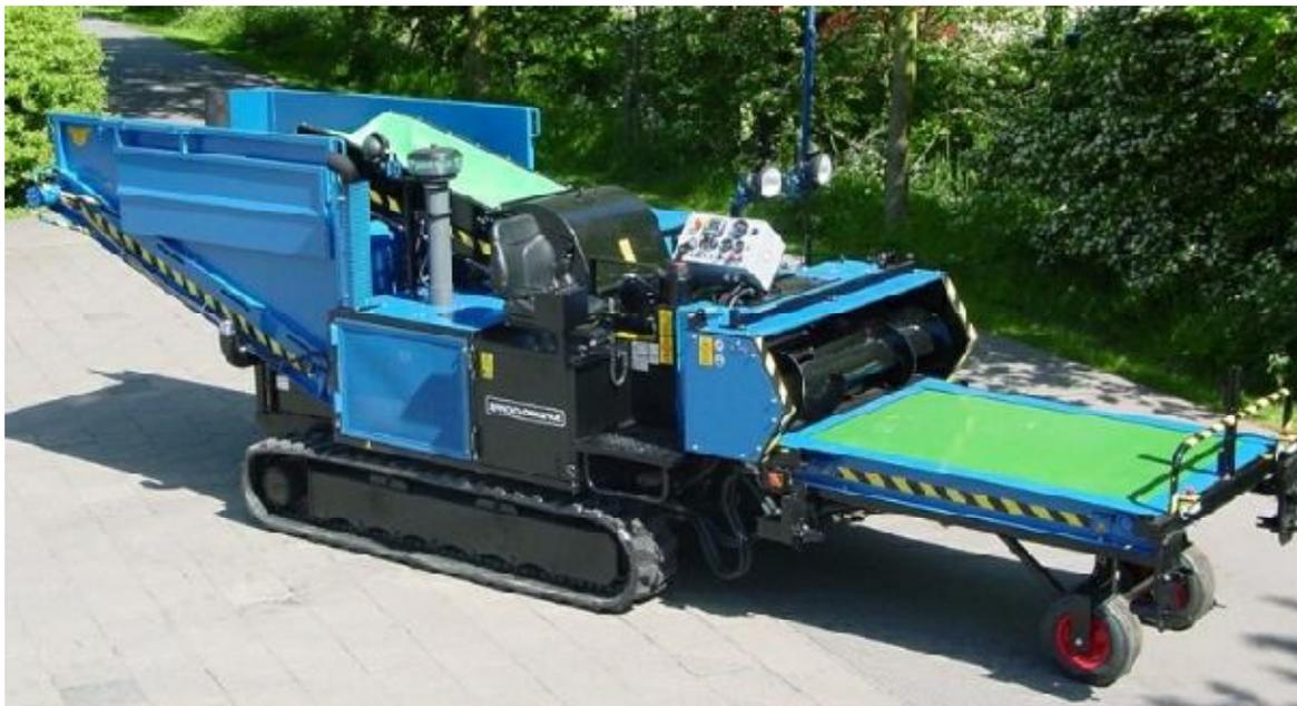
Рисунок 4. Комбинированный комплекс для удаления растительных остатков HW-0751950-V13061301-EN Mega Bio Chopper Shredder
