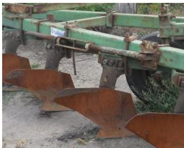
Рисунок 4. Упрочнение несущего бруса рамы плуга ПНЛ-8-40
