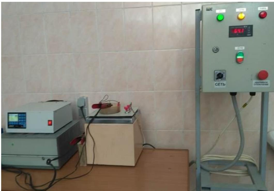
Рисунок 1. Оборудование для нанесения нанокomпозиционных гальванических покрытий
