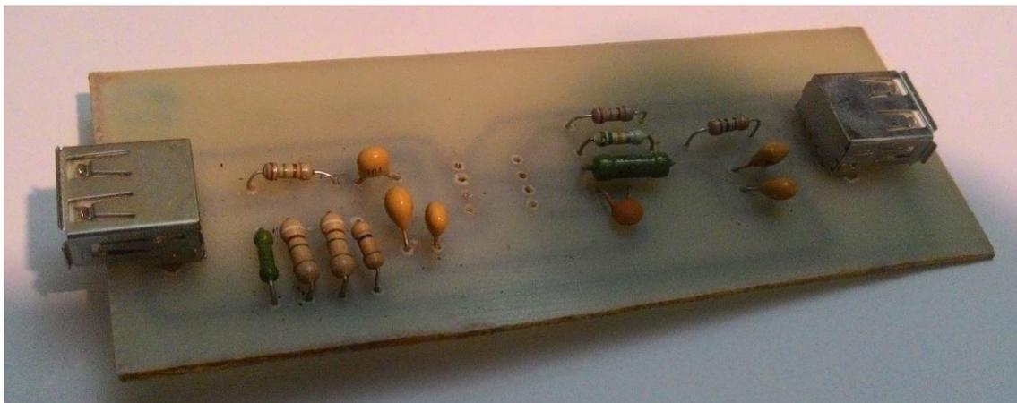
Рисунок 5. Сборка усилителя датчика впрыска топлива
