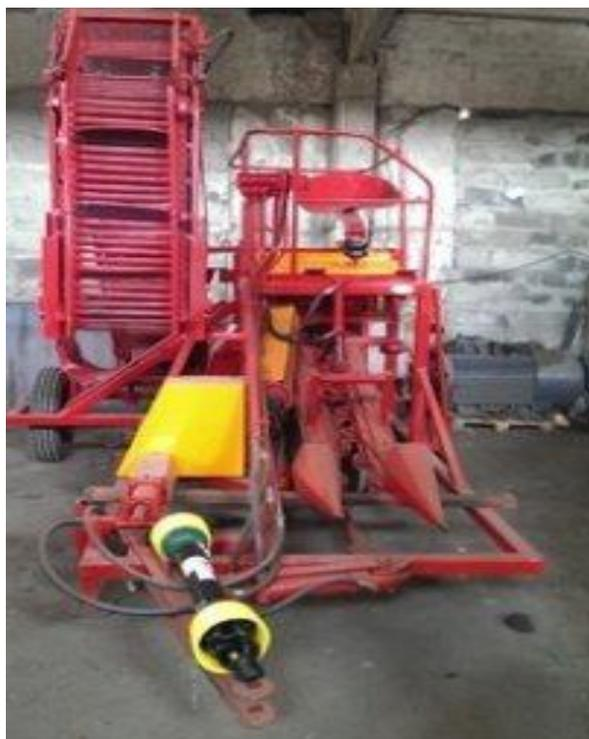
Рисунок 2. Корнеуборочная машина ЕМ-11
