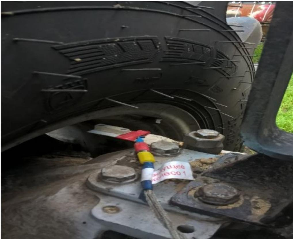
Рисунок 4. Датчики оборотов ведущих колес
