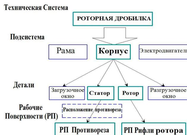
Рисунок 1. Иерархическая схема основных элементов роторной дробилки
