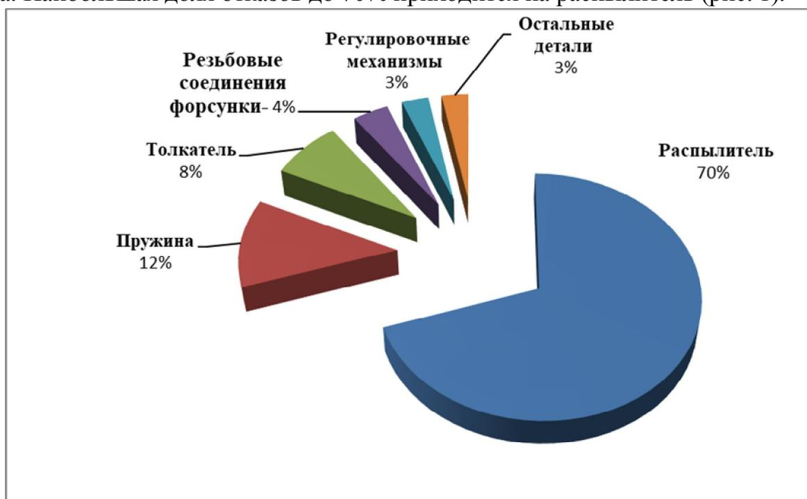
Рисунок 1. Распределение отказов основных деталей форсунки.
