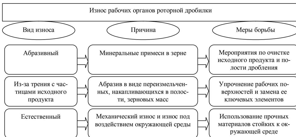
Рисунок 2. Подходы к повышению износостойкости в роторной дробилке
