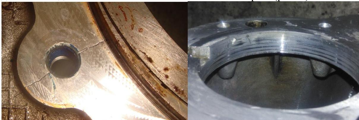
Рисунок 2. Повреждения посадочных мест подшипников
