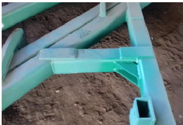
Рисунок 3. Место упрочнения рамы плуга ПБС-8М.
