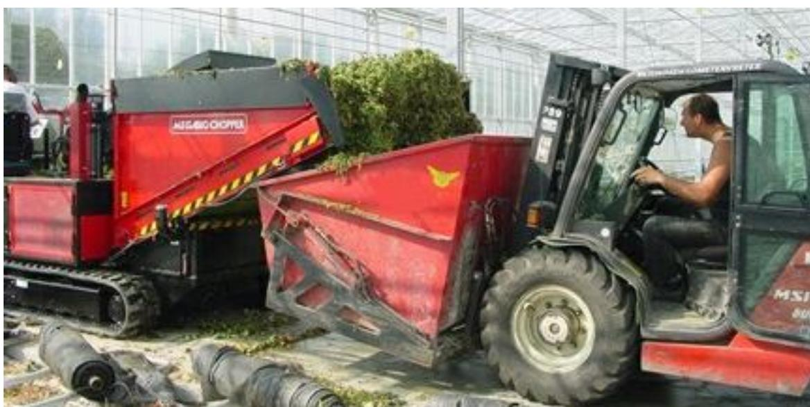
Рисунок 5. Погрузчик с контейнером для удаленной массы от растительных остатков HW-4419210-V12080701-EN Hydraulic crop waste container Super Mega Bio Chopper 2200 liter1
