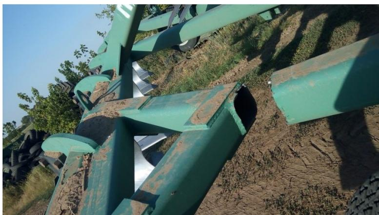
Рисунок 2. Место излома правого поперечного бруса плуга ПБС-8М.
