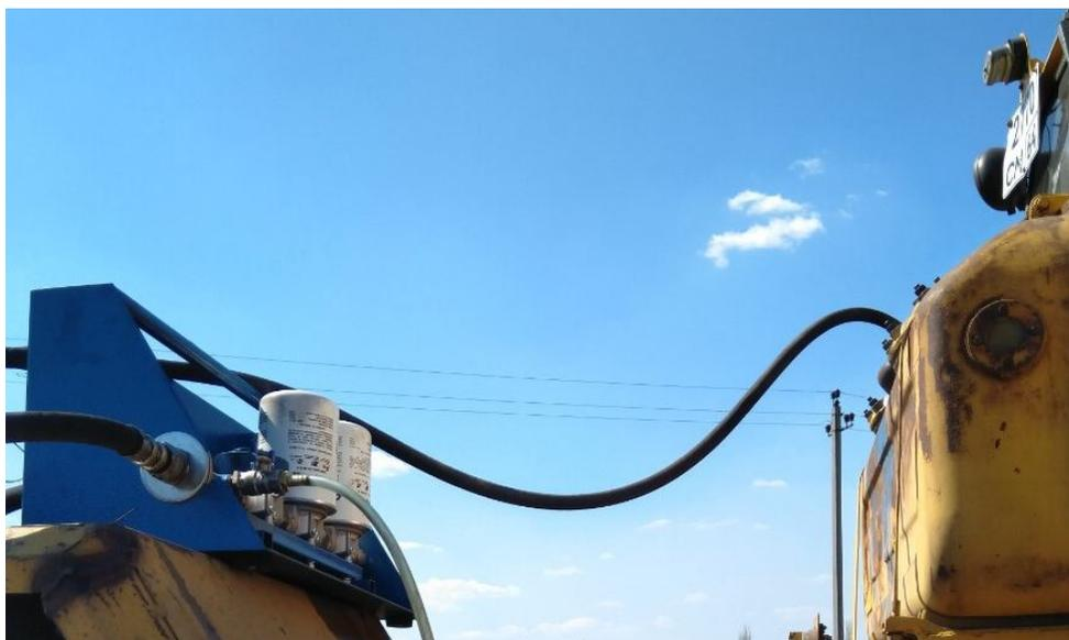
Рисунок 1 – Установка СДО на тракторе
