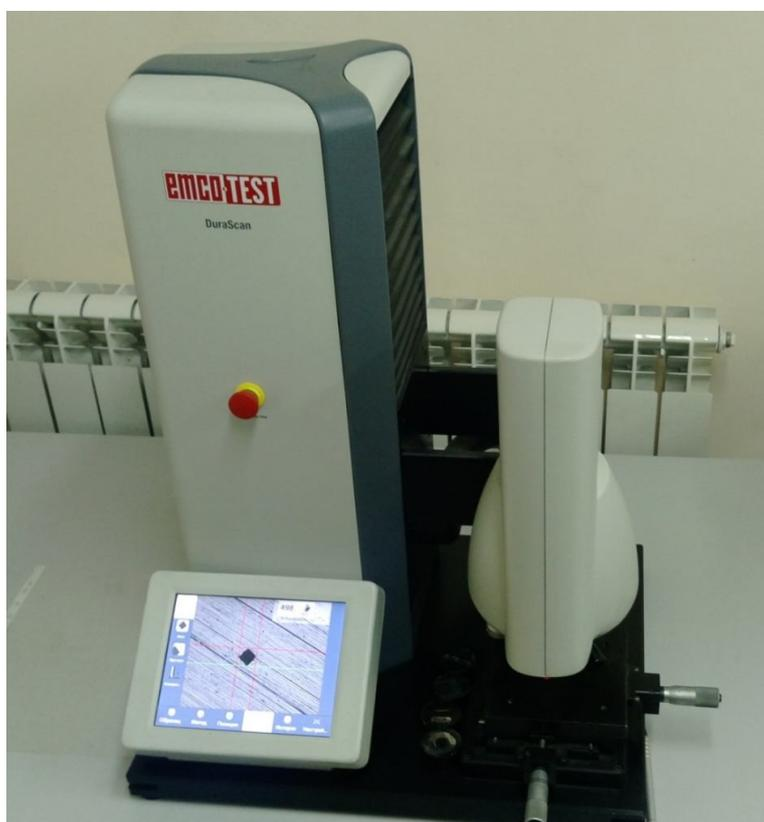
Рисунок 2. Микротвердомер Durascan 20
