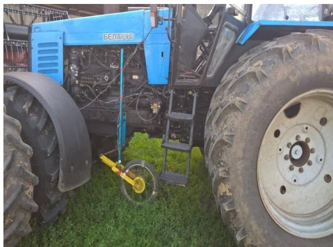
Рисунок 3. «Пятое» путеизмерительное колесо
