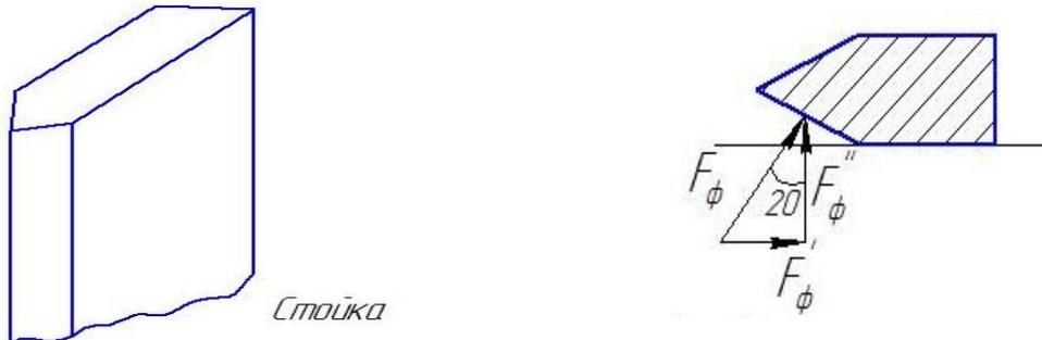
Рисунок 6. Стойка Г-образного ножа
