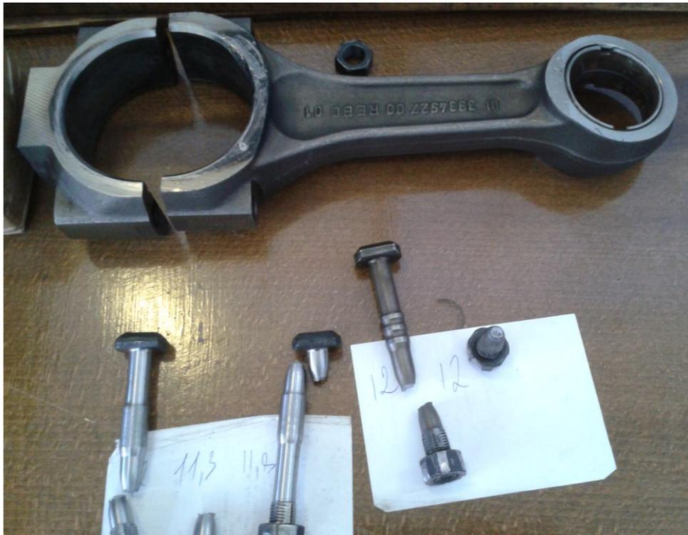
Рисунок 3. Результаты испытания шатунных болтов на растяжение
