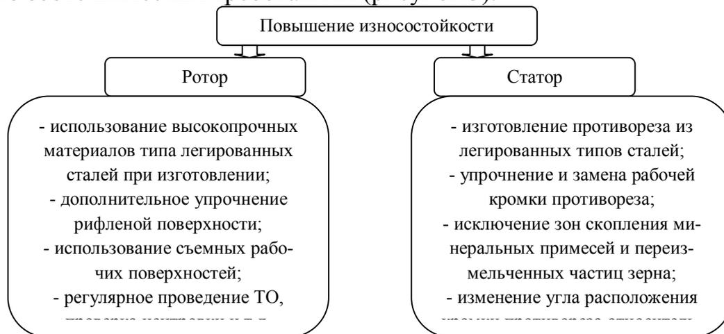
Рисунок 3. Способы повышения износостойкости ротора и статора зернодробилки
