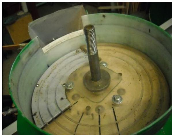
Рисунок 1. Схема и общий вид дисково-штифтового высевающего аппарата: 1 – геликоид; 2 – высевающий диск; 3 – промежуточный диск; 4 – козырек; 5 – подвижные штифты; 6 – ступенчатый сектор
